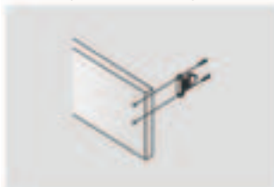
Výškové nastavení čílka: ±2mm Front panel height adjustment: ±2mm
