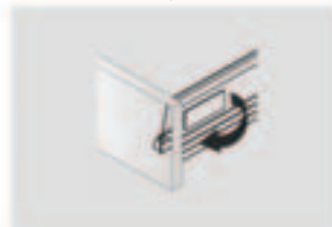
Boční nastavení čílka: levá 1mm Front panel side adjustment: left 1mm
