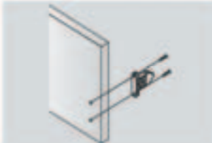
Výškové nastavení čílk: ±2mm Front panel height adjustment: ±2mm
