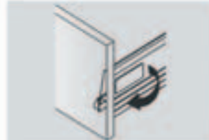
Boční nastavení čílk: levá 1mm Front panel side adjustment: left 1mm
