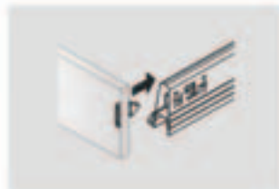
Boční nastavení čílka: pravá 1mm Front panel side adjustment: right 1mm
