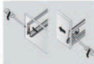
Boční nastavení čílk: levá 1mm Front panel side adjustment: left 1mm
